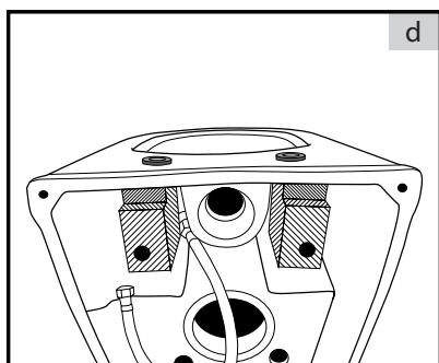
3 a, b, c, d. Plastové bloky (pravý a levý) upevněte na zadní část WC mísy pomocí úchytů skrz otvory pro WC sedátka a dotáhněte pomocí plastového klíče tak, aby nedošlo k jejich uvolnění.
