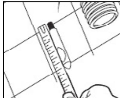
2. Nastavte vzdálenost kotevních úchytů od zdi. Závitové tyče zkráťte dle kotevních úchytů. Vybrání na úchytech nastavte vždy směrem nahoru.
