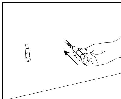
1. Našrouubujte kotevní úchyty na závitové tyče podomítkové nádržky (úchyty jsou součástí montážní sady u každého WC)
