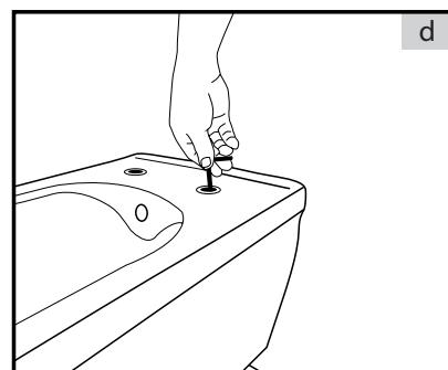
4 a, b, c, d. Nasuňte a usaděte WC mísu na závitové tyče a skrz otvory WC sedátka dotáhněte pomocí imbusového klíče.
